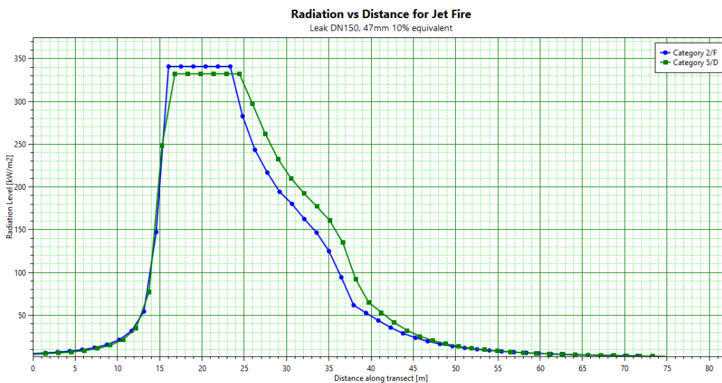
Kuva 5: Metaanin suihkupalon lämpösäteily.
