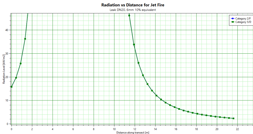
Kuva 8: Metaanin 10 %:n poikkipinta-alavuodon suihkupalon lämpösäteily.
