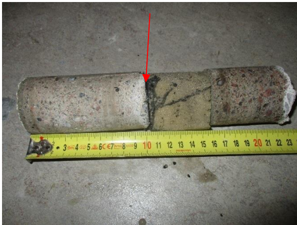
9.1 Rakenneavaus RA.04-US pohjakerroksesta. Punaisella nuolella merkattuna bitumisively
