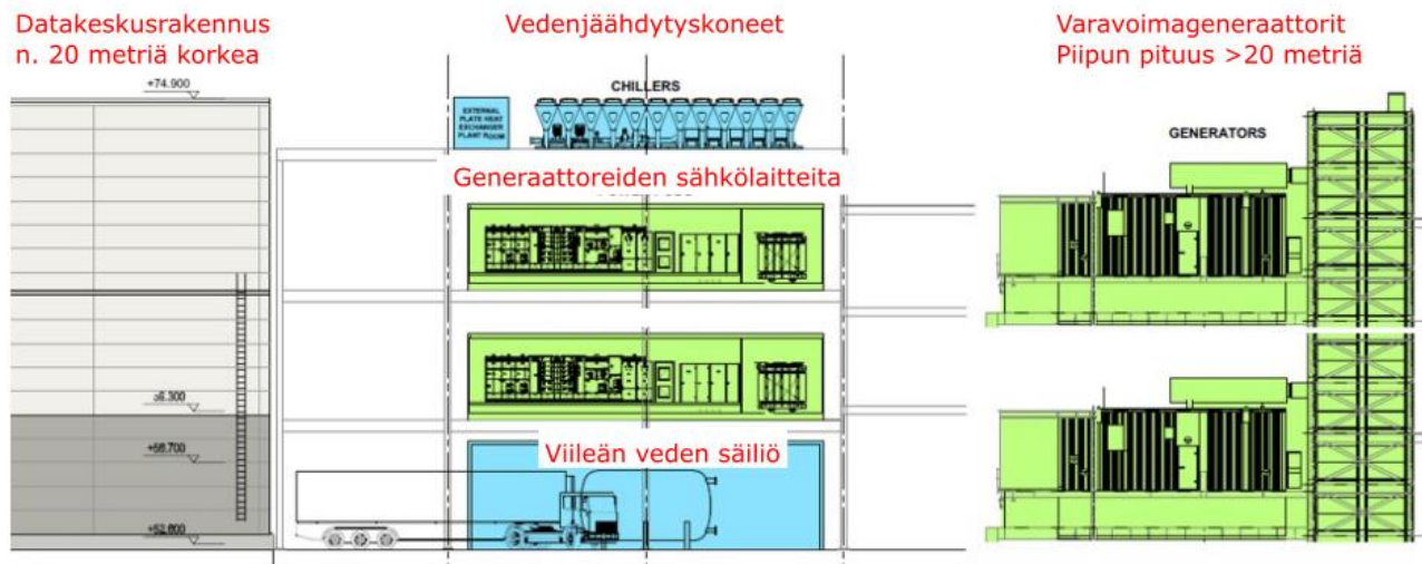
Kuva 4-1. Viitteellinen poikkileikkaus datakeskuksesta. Rakennuksen kattokorkeus ja generaattoreiden savupiippujen pituudet ovat viitteellisiä (piippuja ei ole piirretty kuvaan, mutta piiput ovat oletettavasti rakennusta korkeampia). Varavoimageneraattoreiden tukirakenne on poistettu kuvasta. Kuva on muokattu Hypercon toimittamista suunnitteluaineistoista.
