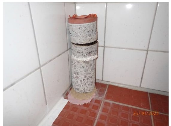
Kuva 21. RAK3 rakennekerrokset näkyvät porauslieriössä.
