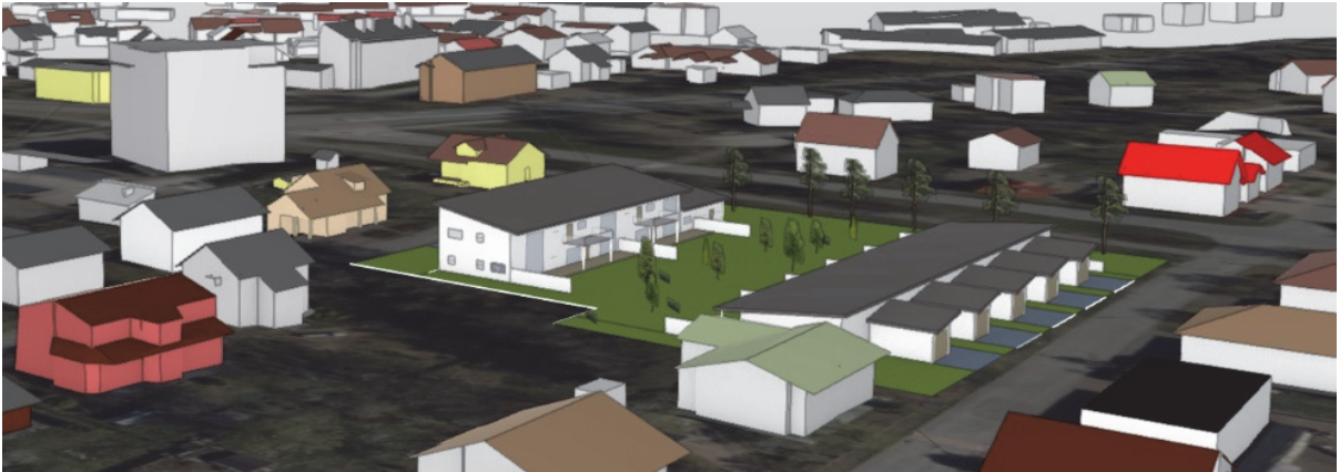
Kuva 7. Esimerkki A kaavaehdotuksen mahdollistamasta rakentamisesta etelän suunnasta katsottuna. Ratkaisussa nykyinen Palomäenkadun puoleinen kookas puusto on säilytetty ja rakentaminen sijoitettu Soininpolun ja Sampsaantien reunoille. Auton säilytyspaikat on sijoitettu kunkin asunnon edustalle. Rakentamisen määrä n. 1000 k-m 2 vastaa tehokkuuslukua e=0,21 .
