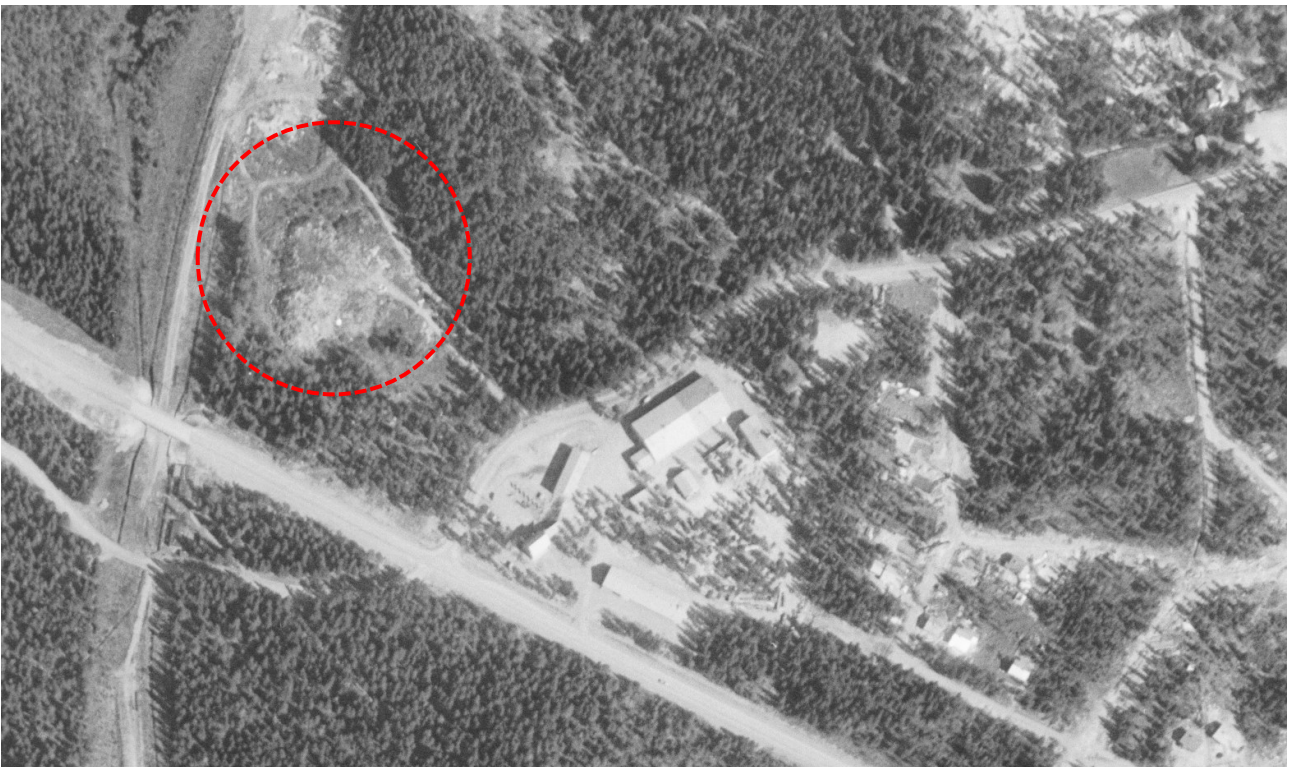
Kuva 12. Vuoden 1960 ilmakuvasa näkyy selkeästi maantäyttöalueen laajentuminen ja sen rajaus. Alueelle on tuolloin ilmeisesti ajettu ylijäämämaita Savonradan rakennustyömaalta. Kuusaantie ja varikko on kuvan mukaan jo rakennettu. Osa Viulukujan varrella sijaitsevista omakotitaloista on myös rakennettu, Kallantien varrella olevia kerrostaloja ei ole. Lähde Maanmittauslaitos, paikkatietoikkuna, 6.11.2023.
