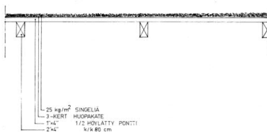
Kuva 102 Vesikattodetalji.
