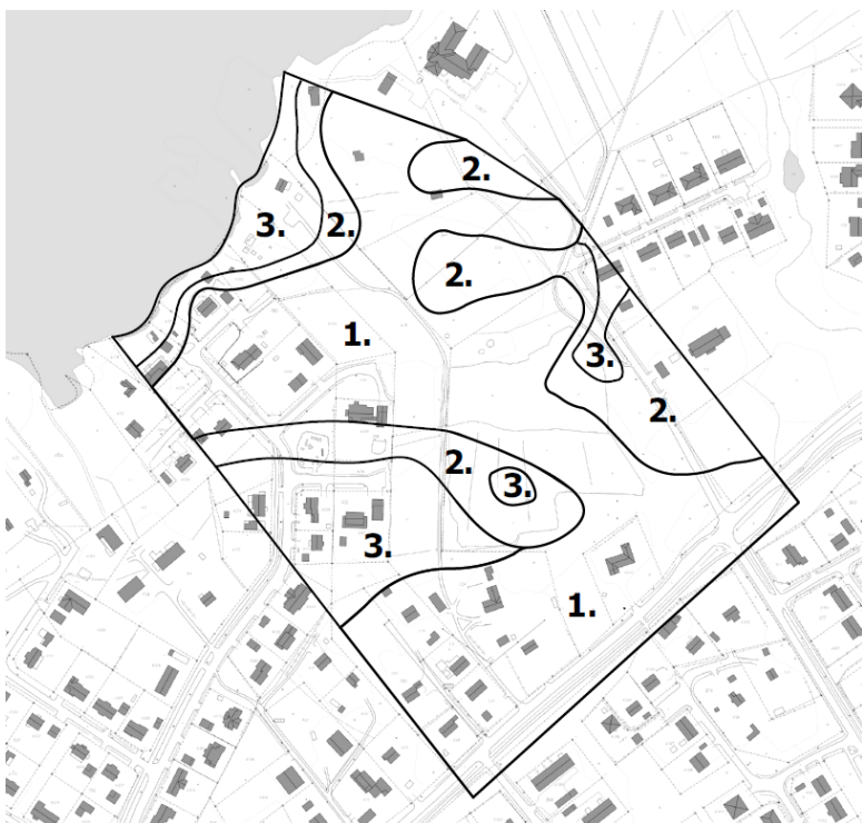
Kuva 5. Rakennettavuusselvityksessä (Ramboll, 2020) esitetyt rakennettavuusvyöhykkeet.
